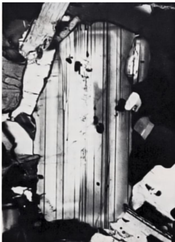
Foto 3. Polysynthetische tweelingen van plagioklaas. Microscopfoto van doorsnede in slijpplaatje, met gepolariseerd licht. Vergroting ongeveer 40 x lineair.
